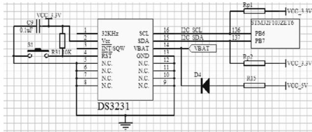
Figure 6. DS3231 Real-time Clock Circuit
