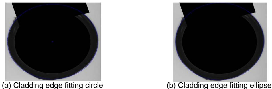
Figure 10. Cladding Edge Fitting
