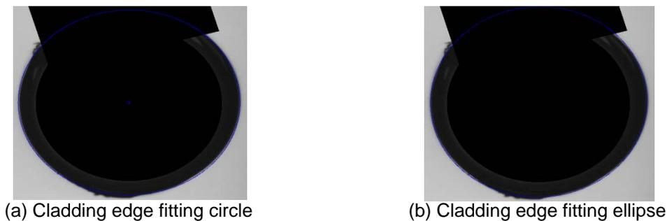
Figure 10. Cladding Edge Fitting
